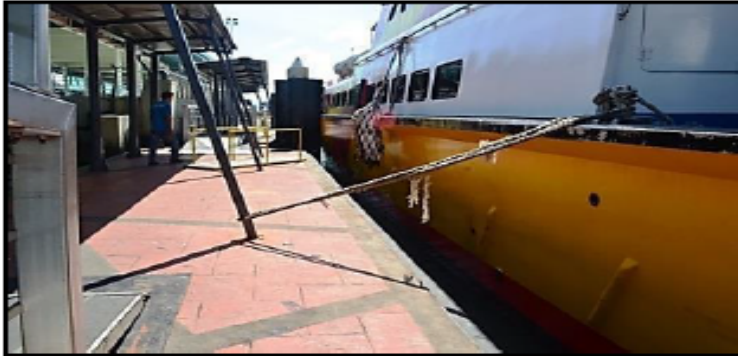
Jeti Kuah, Langkawi, Kedah - Tali Penambat Feri Disangkut Pada Tiang Bumbung Pontoon (5.9.2017)
