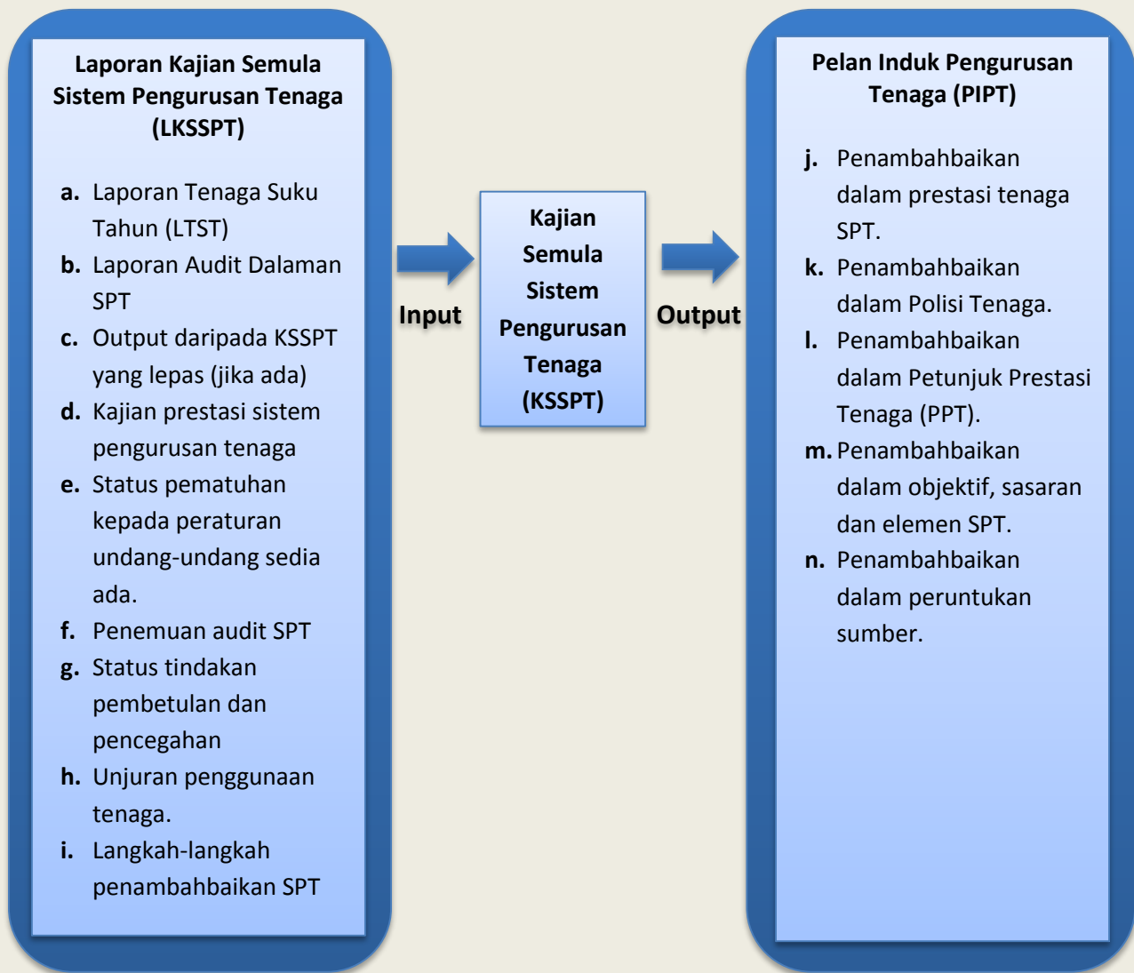
Gambarajah 22 : Input dan output kepada Laporan Kajian Semula Sistem Pengurusan Tenaga (LKSSPT)
