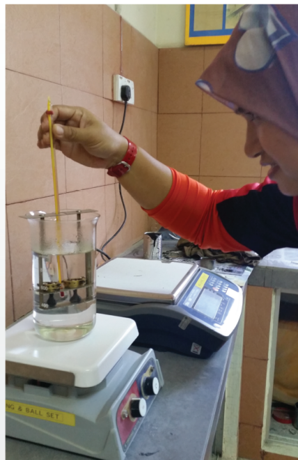
Rekod suhu air sejurus sampel bitumen menyentuh plate pada jarak 25 mm di bawah ring.
