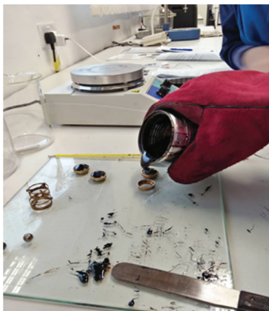
Curah sampel bitumen yang telah dipanaskan ke dalam ring sehingga penuh.
