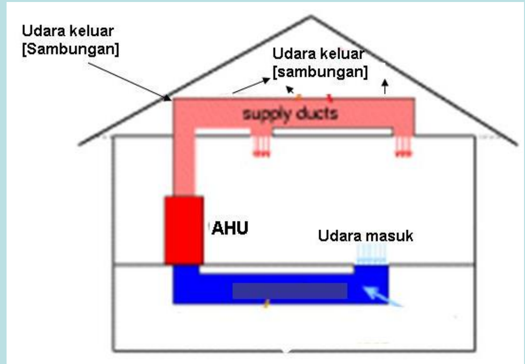
Rajah 2.5-1 : Kawasan kebocoran udara didalam ducting
