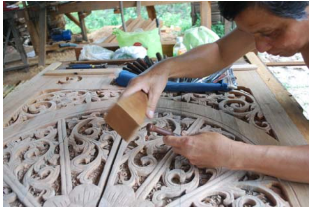
Gambar 4.11: Mengukir kerawang tingkap.
