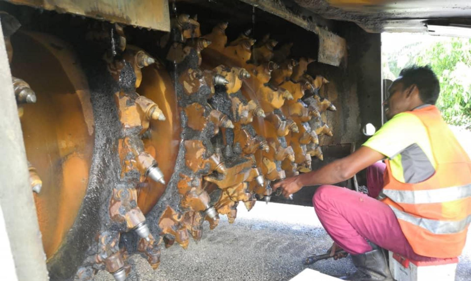
**Cutting tools yang tumpul pada milling machine perlu diganti untuk hasilkan permukaan yang rata selepas mill.**
