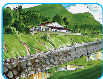
2. Air keluar melalui permukaan tanah di lokasi baharu berhampiran cerun.
