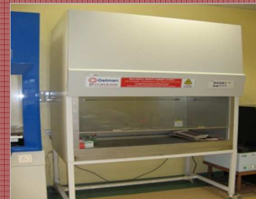
Makmal Patologi - Biohazard Cupboard Tidak Boleh Digunakan Kerana Tidak Diuji
