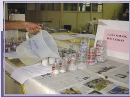
Cairan magnesium sulfat dituang ke dalam bekas sampel.
