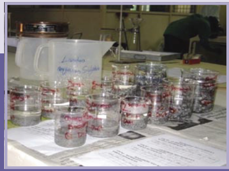
Sampel agregat diasingkan mengikut saiz.
