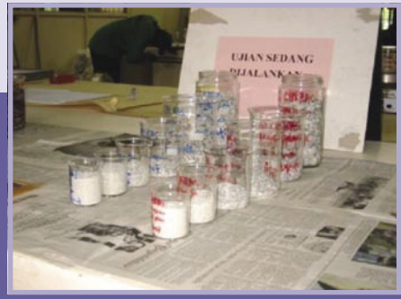
Sampel agregat diasingkan mengikut saiz.
