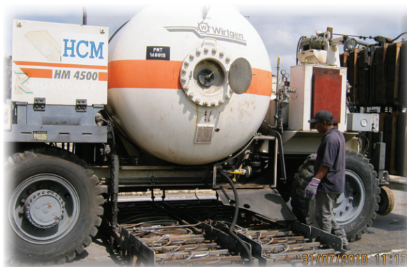
Tangki simpanan LPG pada pre-heater and remixer.
