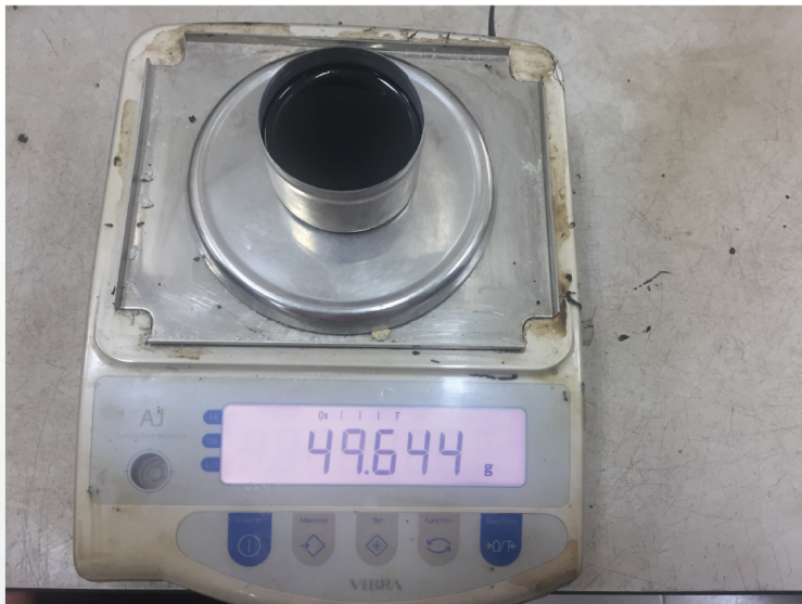
Masukkan sampel sebanyak 50 \pm 0.5 g ke dalam bekas silinder.
