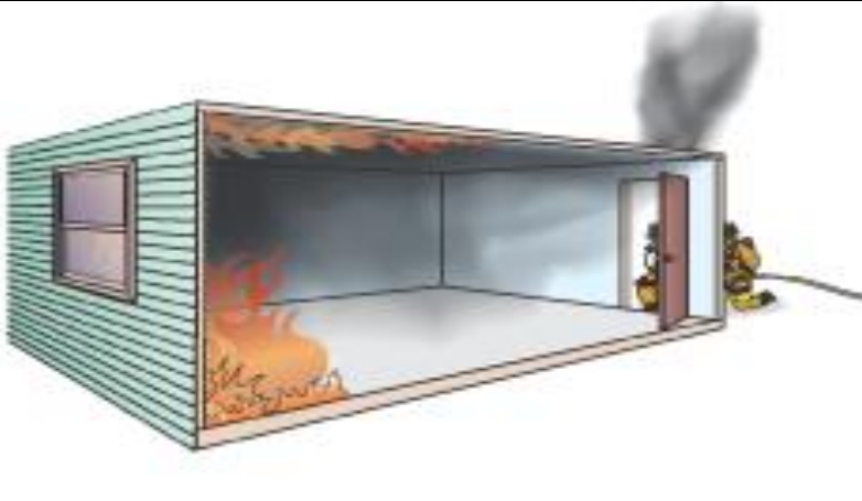
Struktur tanpa pengudaraan
