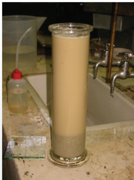
Air ditambah ke dalam silinder sehingga 90% penuh.
