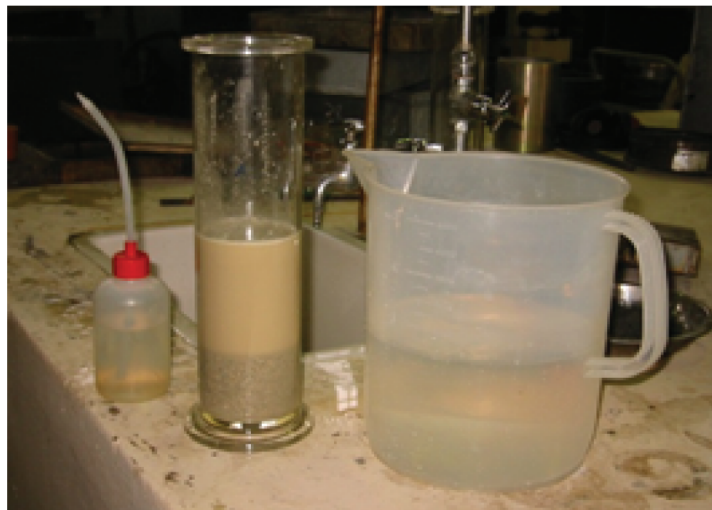
Air dimasukkan secukupnya sehingga sampel tenggelam dan dibiarkan selama kira-kira 24 jam.
