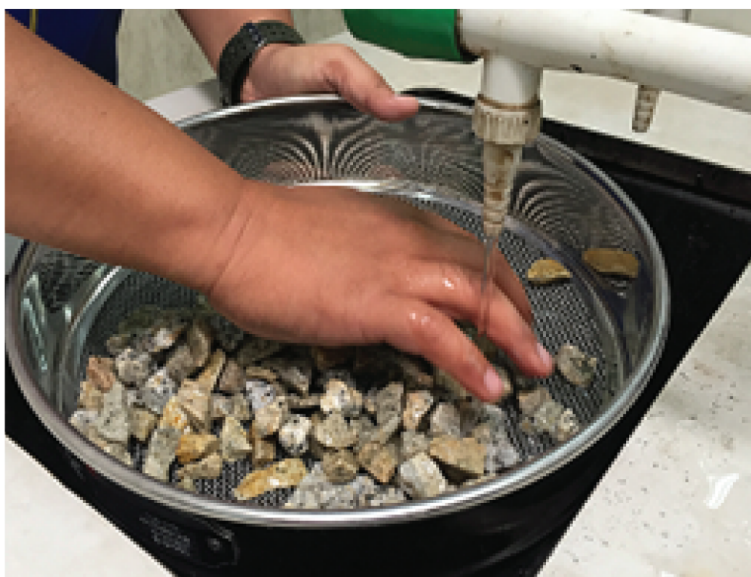
Basuh aggregate dengan aliran air.
