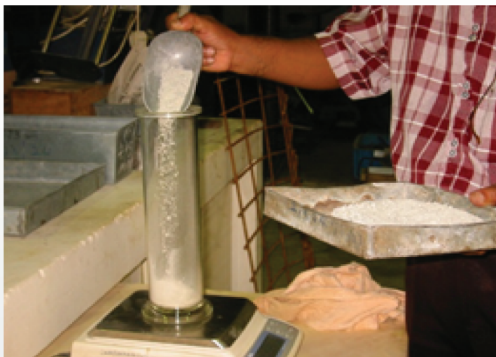
Sampel dimasukkan ke dalam silinder.
