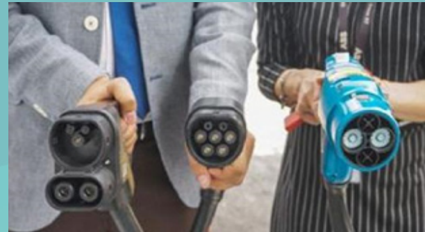
3 jenis rapid charger ( dari kiri : 50kw DC CC2, 43kw AC Mennekes Type 2 and 50kw CHAdeMO)
