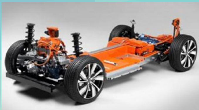
Platform Volvo XC 40 P8 AWD Recharge Dual Electric Motors berkuasa 300 kW ( 402 hp) yang dikuasakan oleh pek bateri 78 kWh dan mampu bergerak sejauh 402 km ( NEDC) dengan sekali cas. (Sumber : InchargeEV, 2019)
