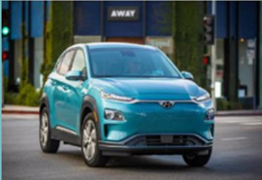
Hyundai Kona Electric merupakan sebuah kenderaan SUV elektrik dikuasakan oleh bateri berkapasiti 64 kwh dan boleh bergerak sejauh 400 km (EPA). ( Sumber : InchargeEV, 2018)
