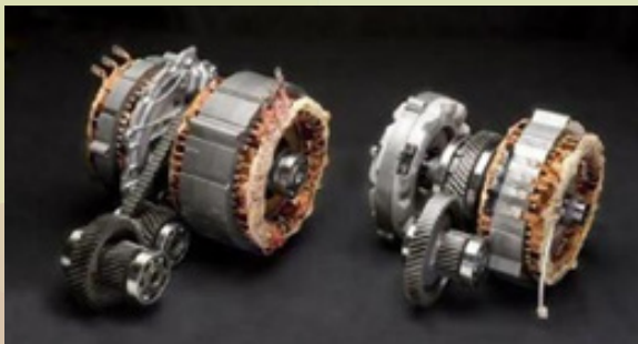
Gambarajah diatas menunjukkan dua unit traction motor dengan fungsi brek regeneratif. Brek regeneratif berfungsi menjana elektrik dari putaran roda dan disalurkan ke bateri. (Sumber : InchargeEV, 2018)
