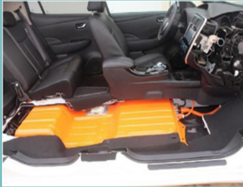
Gambarajah kedudukan pek bateri berkapasiti 60 kwh bagi Nissan Leaf. Kenderaan ini mampu bergerak sejauh 300 km dengan sekali cas (Sumber: InchargeEV, 2017)
