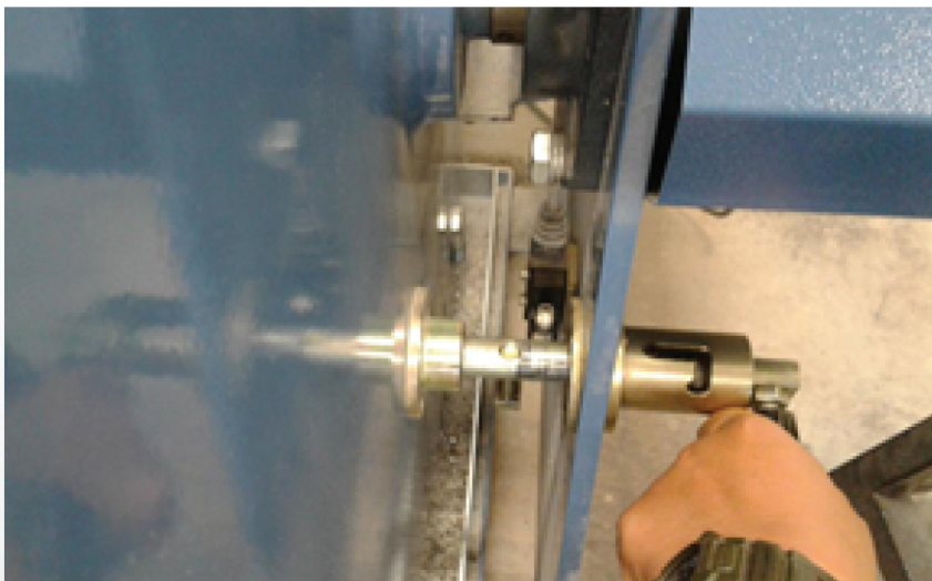
Melepaskan lock keselamatan sebelum ujian.
