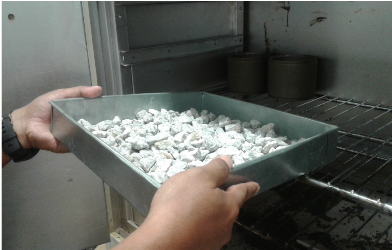
Keringkan sampel di dalam oven selama sejam.
