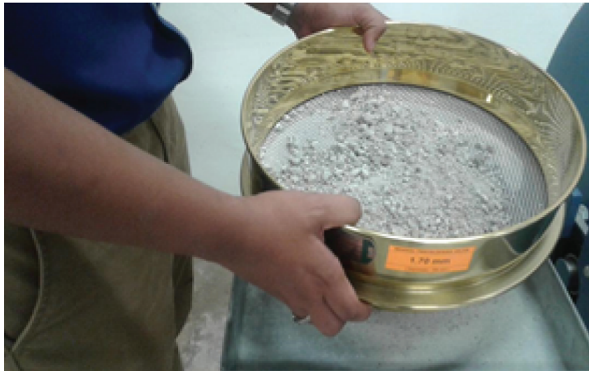
Ayak sampel dengan menggunakan ayak 1.70 mm.
