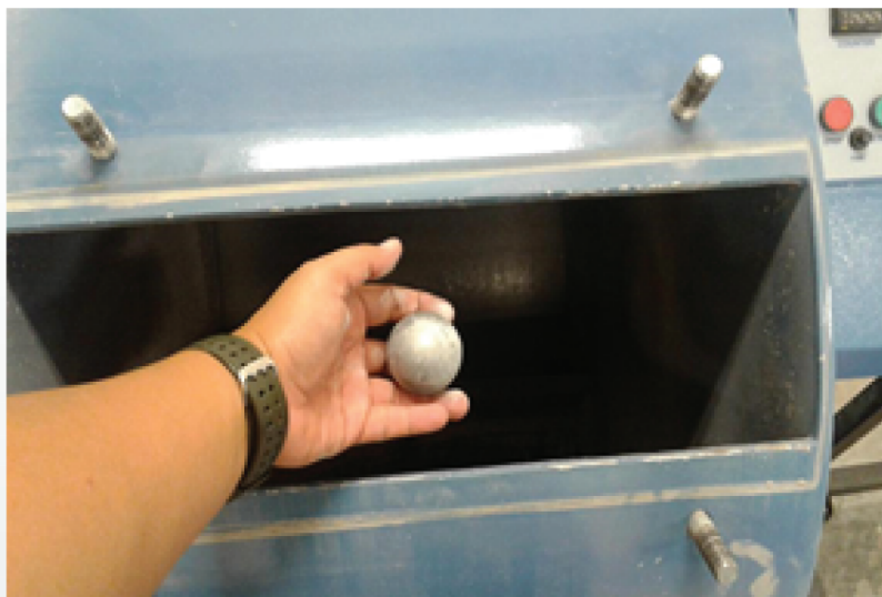
Bebola keluli diletakkan ke dalam peralatan Los Angeles drum.
