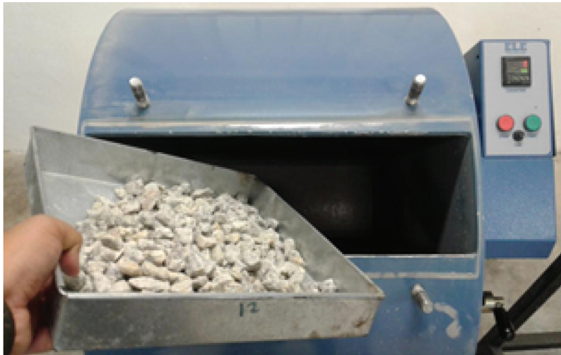
Sampel aggregate dimasukkan ke dalam peralatan Los Angeles drum.
