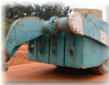
Rajah 5: Proof roller ditarik oleh bulldozer.
