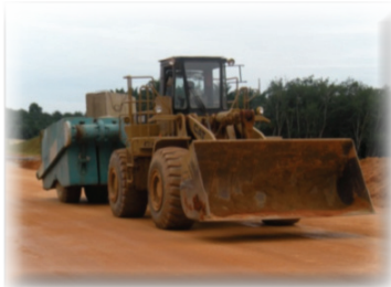
Rajah 1: Proof roller ditarik oleh bulldozer.
