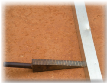
Rajah 3: Pengukuran lekukan selepas proof rolling.
