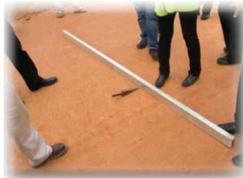
Rajah 2: Pengukuran lekukan selepas proof rolling.
