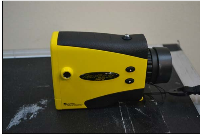
Gambar 7: True Pulse untuk mencerap jarak penglihatan
