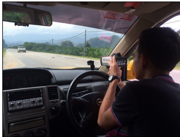
Gambar 5: Halaju setempat disukat menggunakan alat Pro Laser III
