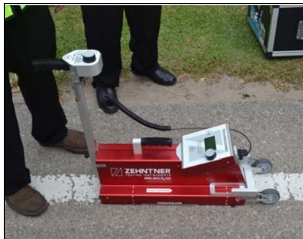
Gambar 3: Ujian kadar pantulan garisan jalan menggunakan Zehntner Reflectometer ZRM 6013
