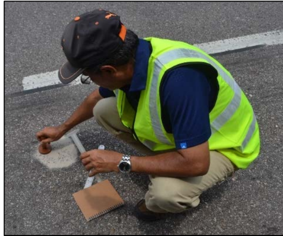
Gambar 1: Ujian kedalaman tekstur dengan kaedah 'sand patch'
