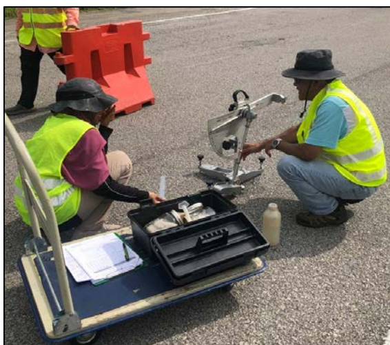
Gambar 2: Ujian Rintangan Gelinciran menggunakan alat British Pendulum Tester (BPT)
