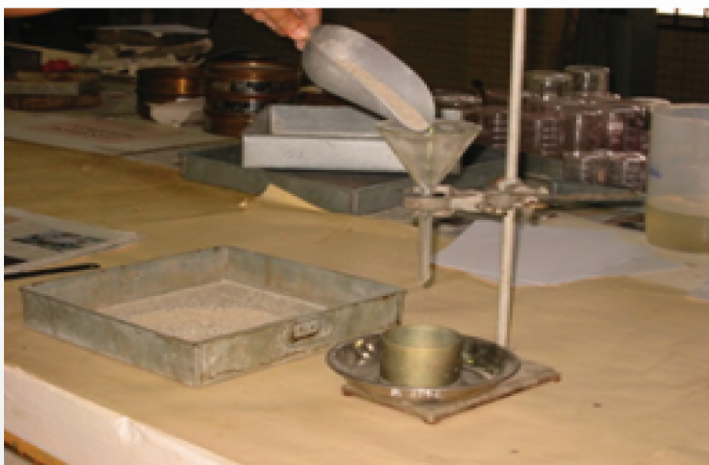
Masukkan sampel ke dalam corong dan letakkan silinder 100 ml tepat di bawah corong tersebut.
