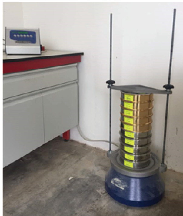
Ayak aggregate dengan menggunakan mechanical shaker.
