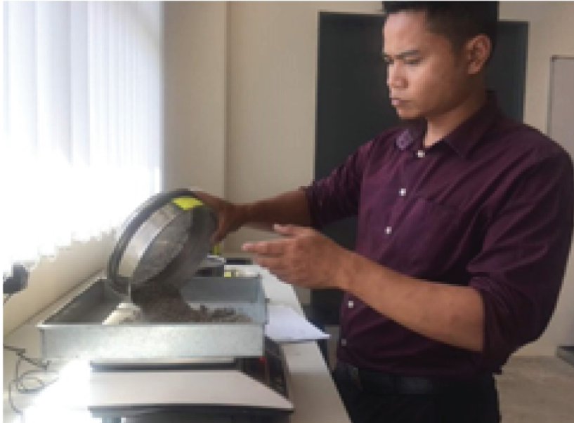
Aggregate yang tertahan pada setiap ayak (WYak) dengan memasukkannya ke dalam tray.
