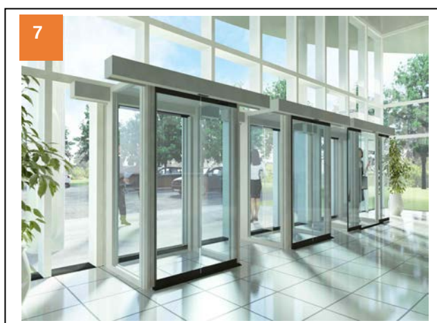
Gambar 7-8: Sistem pintu 'airlock' yang dapat memastikan haba dan suhu luar-dalam bangunan dapat distabilkan
