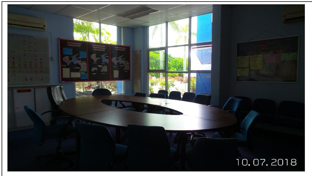
Gambar 20: Keadaan bilik mesyuarat yang kurang pencahayaan walaupun dengan pencahayaan siang dan memerlukan bantuan cahaya buatan. Pemilihan warna dan material yang gelap turut menyebabkan keadaan bilik ini menjadi gelap.
