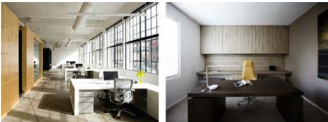
Gambar 12-13: Imej menunjukkan kedudukan meja kerja yang bersudut tepat dengan tingkap untuk mengurangkan silau
