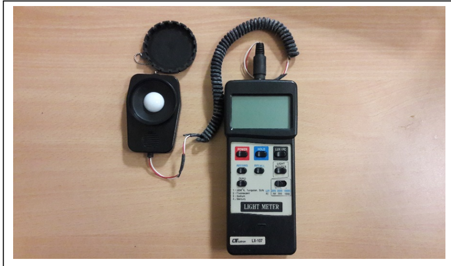
Gambar 14: Lux Meter yang digunakan untuk mengukur cahaya
