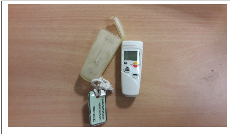
Gambar 25: Gambar menunjukkan alat “Infrared Thermometer” (Testo 805) yang digunakan untuk mengukur suhu
