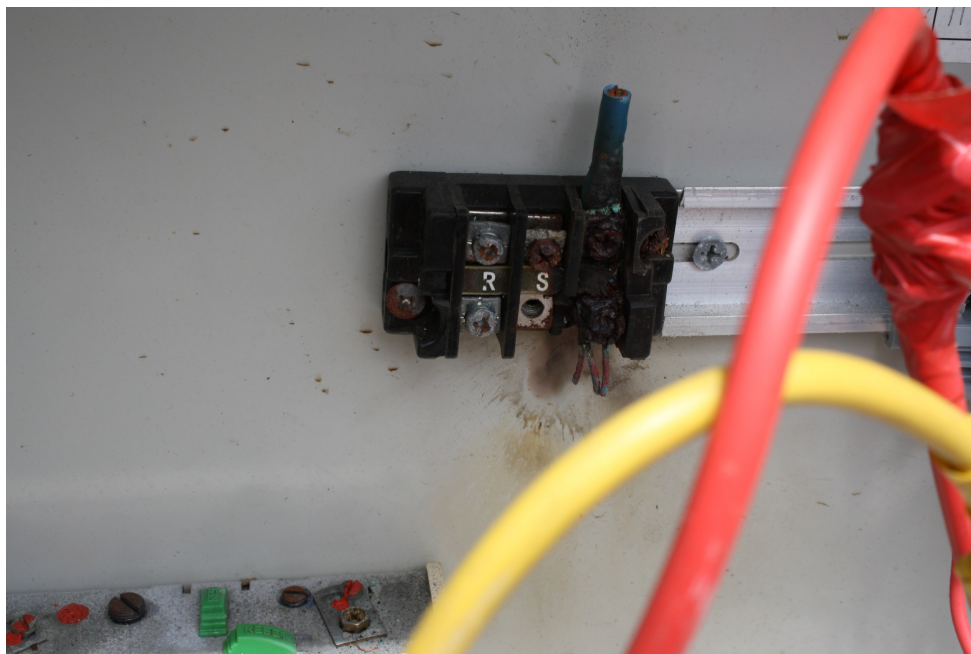
Gambar 1: Kesan terbakar pada connector didalam unit outdoor
