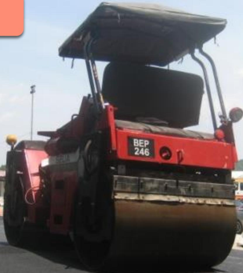
Padatkan asphalt dengan roller
