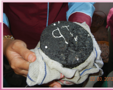
Mengeringkan permukaan spesimen tepu dengan tuala lembap.
