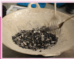
Menggaul bitumen dengan agregat.
