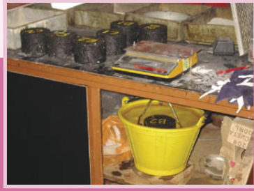
Menimbang berat spesimen di dalam air.
