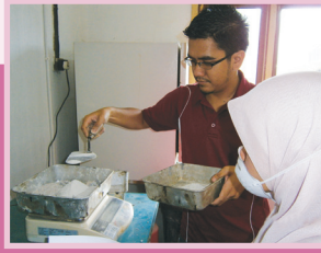
Proses menimbang setiap saiz agregat.
