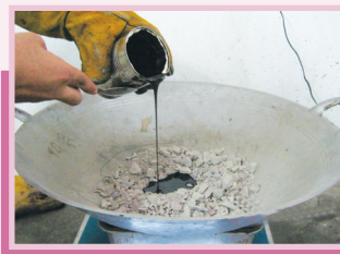
Mencampurkan bitumen ke dalam agregat.
