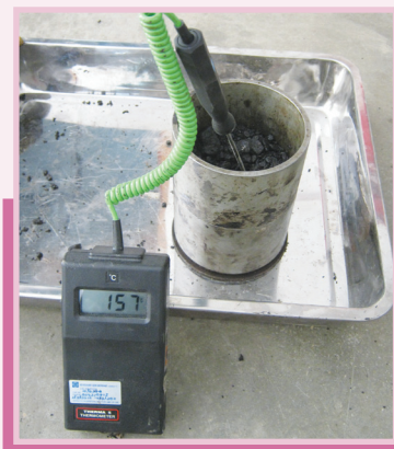
Suhu pemadatan \pm 135^{\circ}\text{C} .
