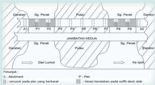
Rajah 1: Rajah lakaran lokasi kerosakan jambatan
