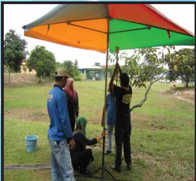
Rajah 6: Kerja-kerja JKR Probe dijalankan secara manual
