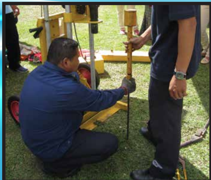
Rajah 9 :Ujian manual dan Motorized JKR Probe
