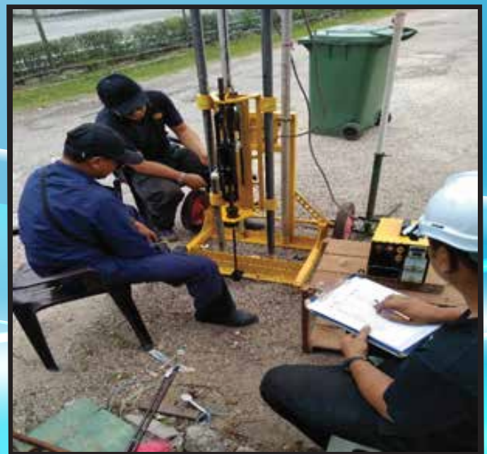
Rajah 8: Kerja pengambilan data bagi Motorized JKR Probe
