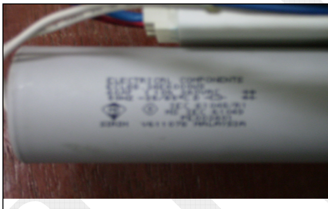
GAMBAR 12: Capacitor yang digunakan jenama Electrical Component berkadaran 40 \mu F 250V
