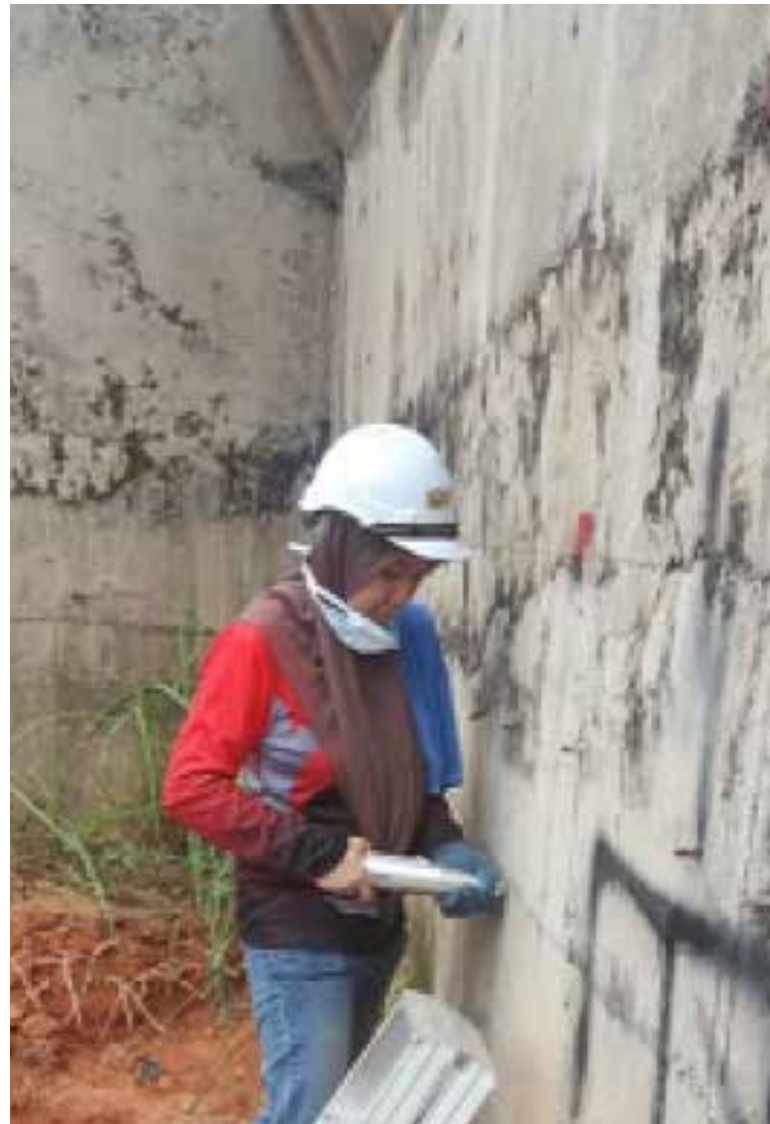
Pengujian menggunakan rebound hammer.
