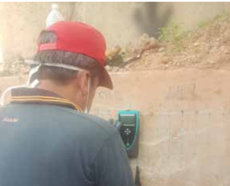
Pengesanan kedudukan tetulang keluli menggunakan covermeter.
