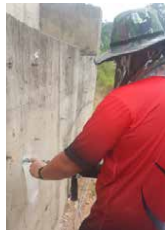
Ujian carbonation pada konkrit.
