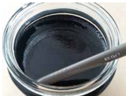
Butiran crumb rubber di dalam CRMB dapat dilihat dengan mata kasar.
