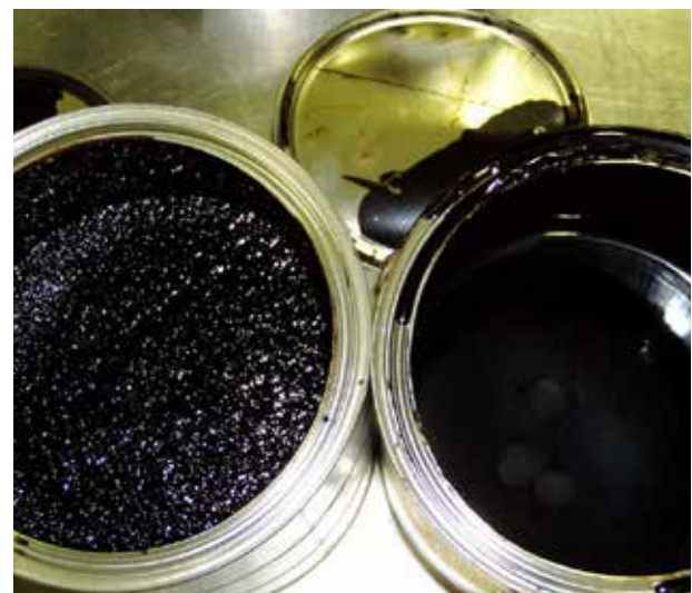
Bancuhan field blending (kiri), terminal blending (kanan).
