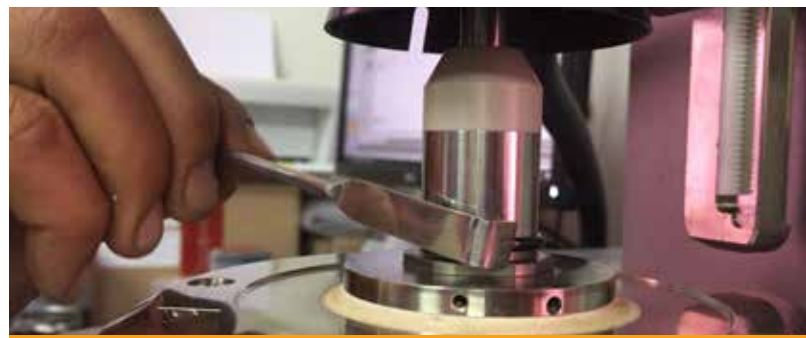
Sampel binder dirapikan untuk ujian DSR.
