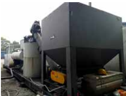
Tangki di mana crumb rubber disimpan sebelum dimasukkan ke dalam tangki pembancuh.
