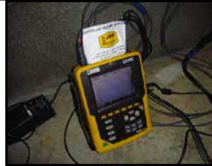
Power Logger Yang Digunakan Untuk Mengukur Penggunaan Tenaga Elektrik Peralatan Mekanikal
