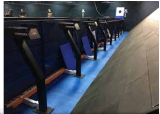
Flipping Target 25 Meter Dilengkapi Dengan Motorised System Dan Bullet Catcher Yang Menggunakan Rubber Block Sebagai Tembok Pelindung Menahan Kesan Tembakan Untuk Tujuan Keselamatan
