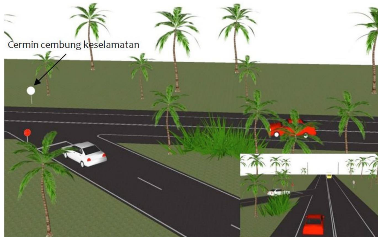
Rajah 4.10.3: Semasa mendaki (crest), cermin keselamatan boleh membantu pemandu kenderaan akan objek yang datang dari arah yang bertentangan
