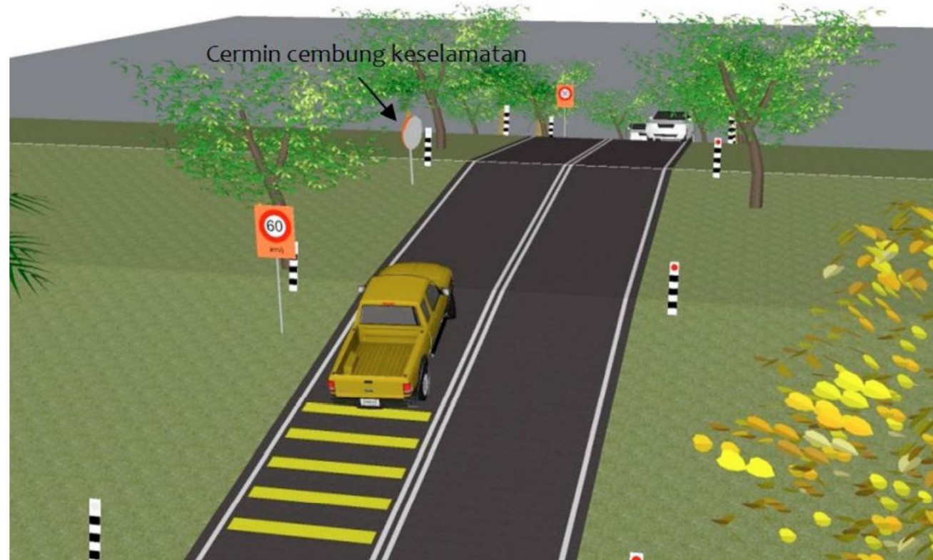
Rajah 4.10.4: Di persimpangan tiga (jenis T atau Y) yang mana kenderaan yang ingin membelok masuk ke jalan utama menghadapi sudut pandangan yang sukar
