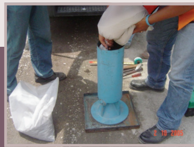
Ujian pemadatan menggunakan kaedah sand replacement bagi menentukan darjah kepadatan lapisan yang dikitar semula.
