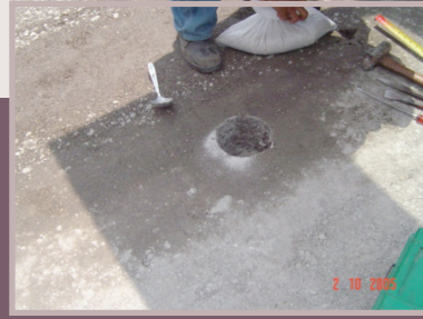
Ujian tebukan bagi menentukan ketebalan lapisan yang dikitar semula.
