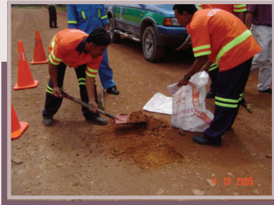
Pengambilan sampel dari trial pit.
