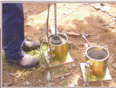
Penyediaan sampel untuk Ujian Kekuatan Mampatan.
