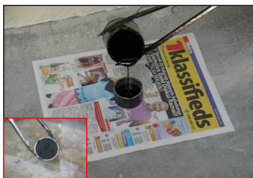
Sampel dimasukkan ke dalam acuan khas yang bersaiz 55mm Ø x 35mm dalam
