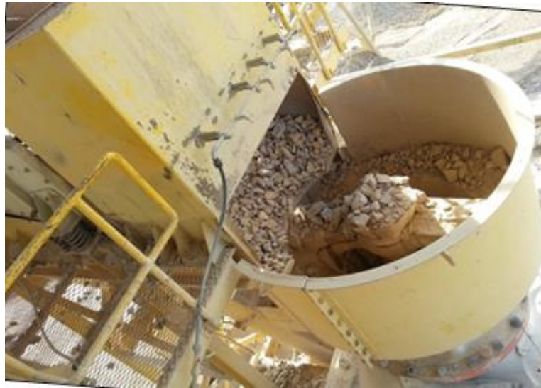
Rajah 4.5.3.2 : Secondary crusher
