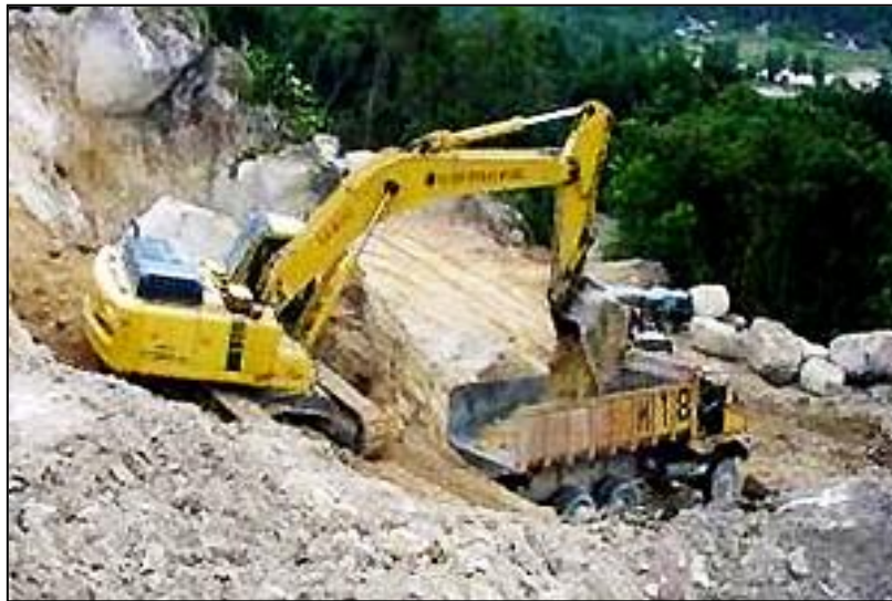
Rajah 4.1.2 : Pembuangan Overburden dengan menggunakan Jengkaut Hidraulik dan Lori
