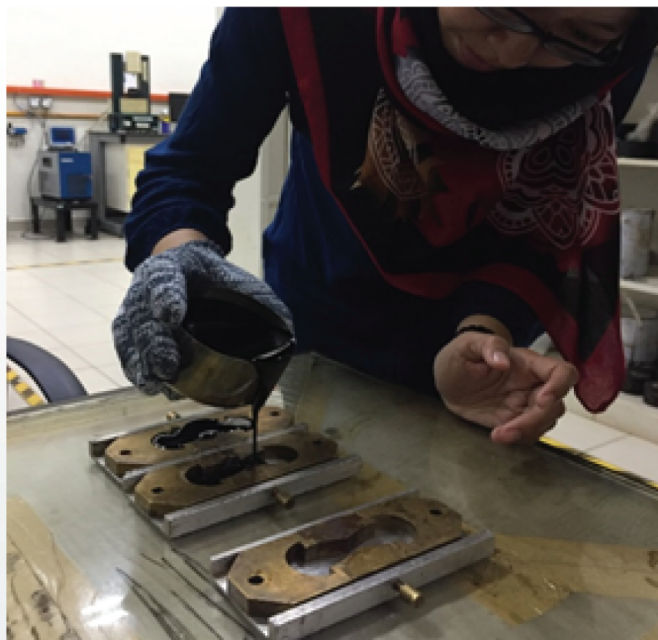
Tuang sampel bitumen ke dalam mold sehingga melimpah sedikit dari aras penuh.
