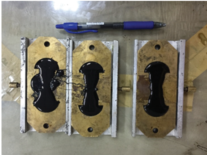
Sampel bitumen di dalam mold bagi ujian ductility.
