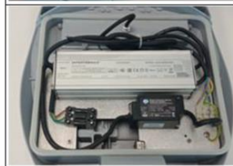
Gambar 5 Road Lighting (LED) - Pandangan Dalam
