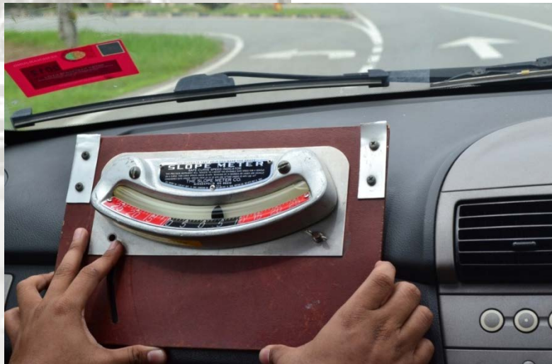
Kakitangan Unit Forensik Keselamatan Jalan sedang menjalankan ujian penentuan halaju selamat di selekoh menggunakan alat 'ball bank indicator'
