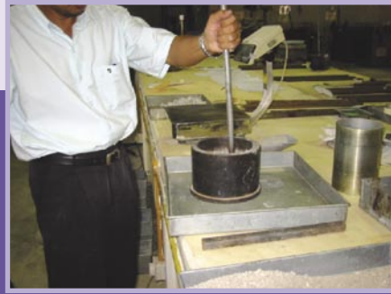
Gambar 2 : Hentak permukaan setiap lapisan dengan batang keluli sebanyak 25 kali.
