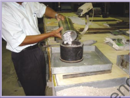
Gambar 3 : Alihkan sampel ke silinder besi bergaris pusat 6 inci dalam 3 lapisan yang sama ketebalan.
