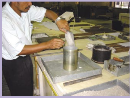
Gambar 1 : 3 lapisan dengan ketebalan yang sama dimasukkan ke dalam silinder bergaris pusat 4 1/2 inci dan ketinggian 7 inci sehingga penuh.
