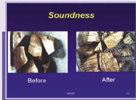
Gambar 4 : Kerosakan pada agregat selepas proses pengeringan-penyejukan boleh dilihat dengan mata kasar serta perubahan pada gredan.
