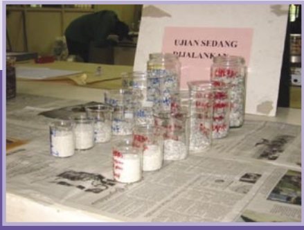
Gambar 1 : Sampel agregat diasingkan mengikut saiz.
