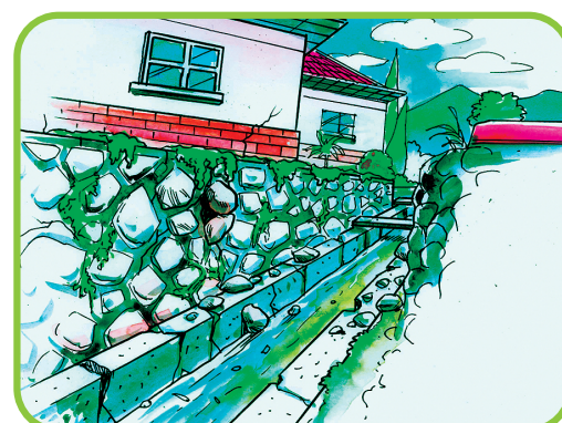
4. 斜坡或挡土墙的底部出现地面隆起状况。
