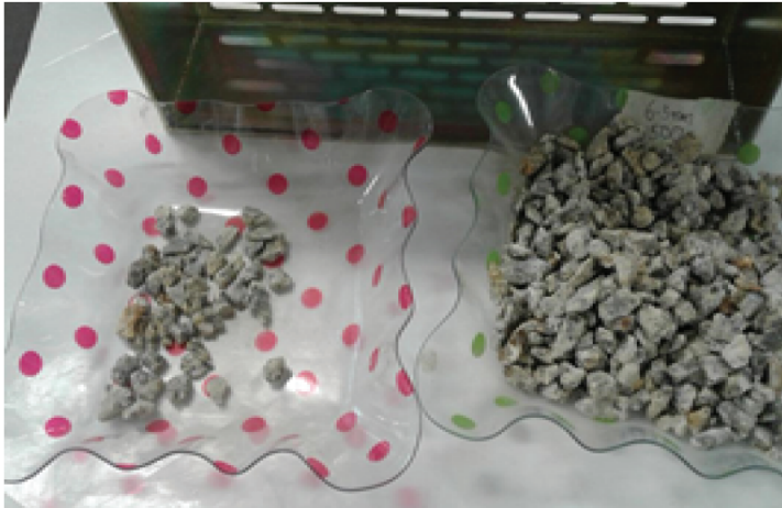
Aggregate yang melewati dan tertahan pada thickness gauge.
