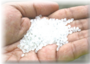
Bahan polymer yang dicampurkan dengan bitumen.
