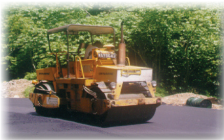
Dimampatkan dengan 'static steel wheel tandem roller' sahaja.
