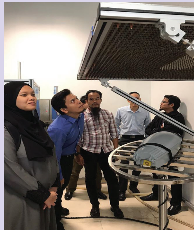
Peserta melihat dengan lebih dekat peralatan water drip tester bagi Ujian Perlindungan terhadap cecair.
