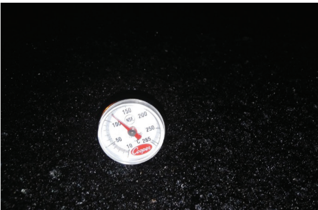
Suhu pemadatan warm mix asphalt 115 \pm 5 °C.
