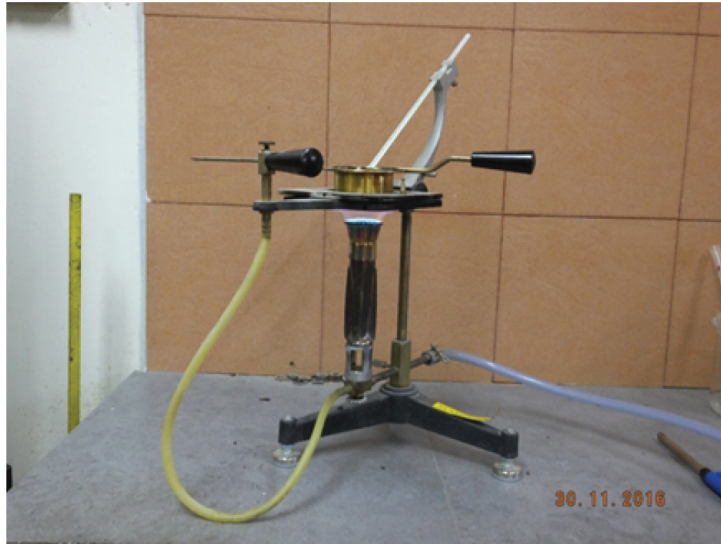
Panaskan bitumen dengan menggunakan penunu bunsen dari bawah cawan ujian.
