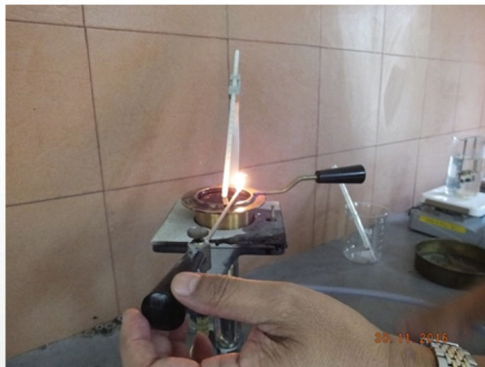
Gerakkan api kecil melintasi permukaan atas bitumen bagi setiap kenaikan suhu 2^{\circ}\text{C} tidak lebih 2 mm dari permukaan bitumen. Bagi setiap pergerakan api kecil tersebut hendaklah dibuat dalam satu arah, dalam masa 1 saat.
