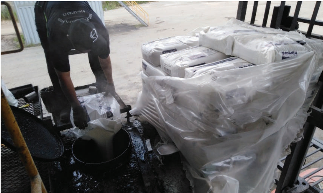
Bahan tambah dimasukkan ke dalam tangki bitumen untuk bancuhan bahan pengikat di kuari TKC Premix, Pagoh.
