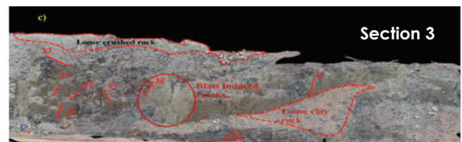
Rajah 7 Gabungan point cloud daripada TLS dan DCRP.
