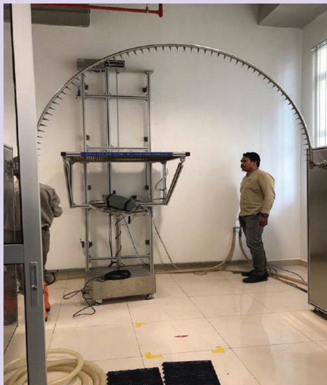
Penerangan berkaitan peralatan yang digunakan bagi Ujian Perlindungan terhadap cecair.
