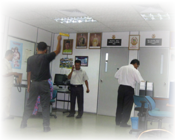
Mengambil bacaan suhu bilik menggunakan sling termometer
