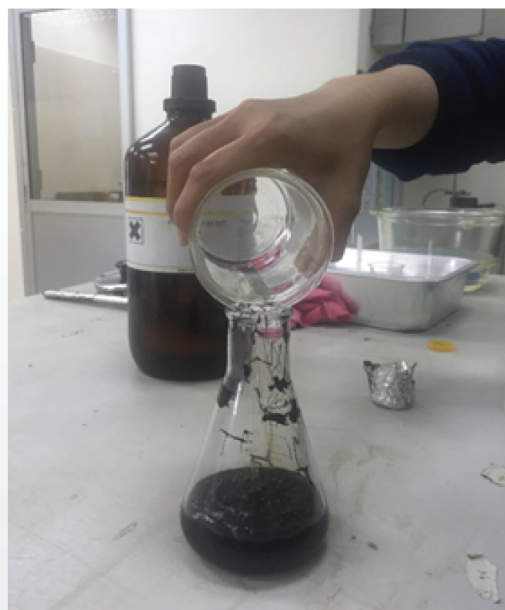
Masukkan 100 ml trichloroethylene ke dalam flask atau bikar.
