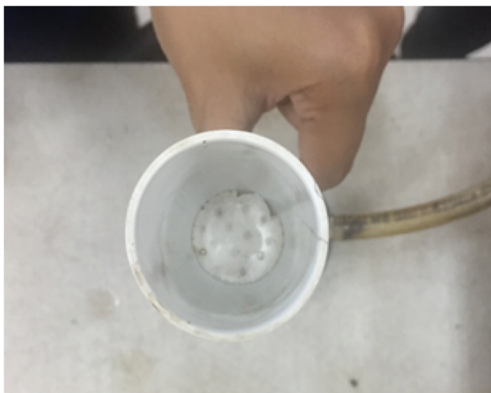
Tuang larutan trichloroethylene sehingga cecair yang ditapis melalui fibre pad kelihatan jernih.
