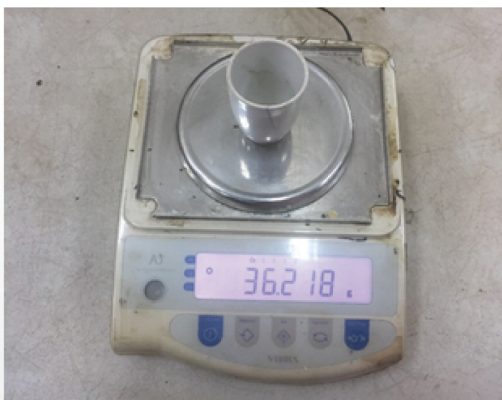
Timbang crucible selepas dikeringkan di dalam oven pada suhu 110 \pm 5^\circ\text{C} tidak kurang dari 20 minit.
