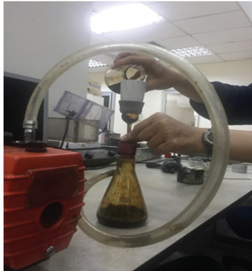
Curah larutan trichloroethylene ke dalam filter flask sedikit demi sedikit sampai habis.
