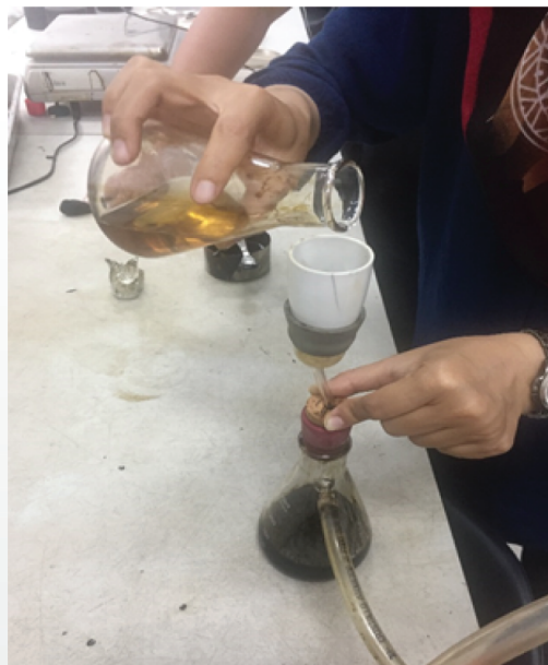
Bilas flask dengan larutan trichloroethylene dan tuang ke dalam filter flask. Ulang sehingga flask itu bersih dari larutan.
