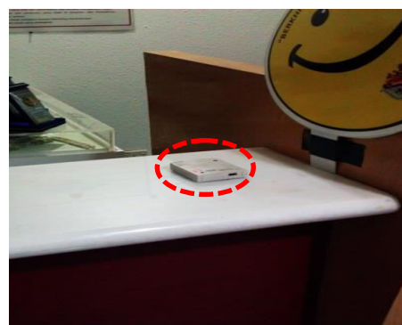
Hobo logger diletakkan di dalam pejabat untuk mengukur wap air dalam udara ketika ujian infiltrasi sedang dibuat.
