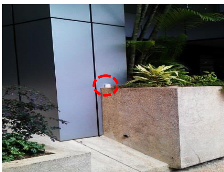
Hobo logger diletakkan di luar (berdekatan dengan lobi) bangunan bagi mengukur wap air dalam udara luar
